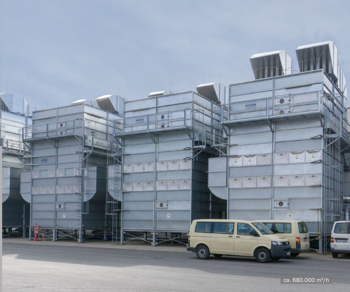
MultiStar Rührwerkaustragefilter mit Jetabreinigung • Küchenindustrie
