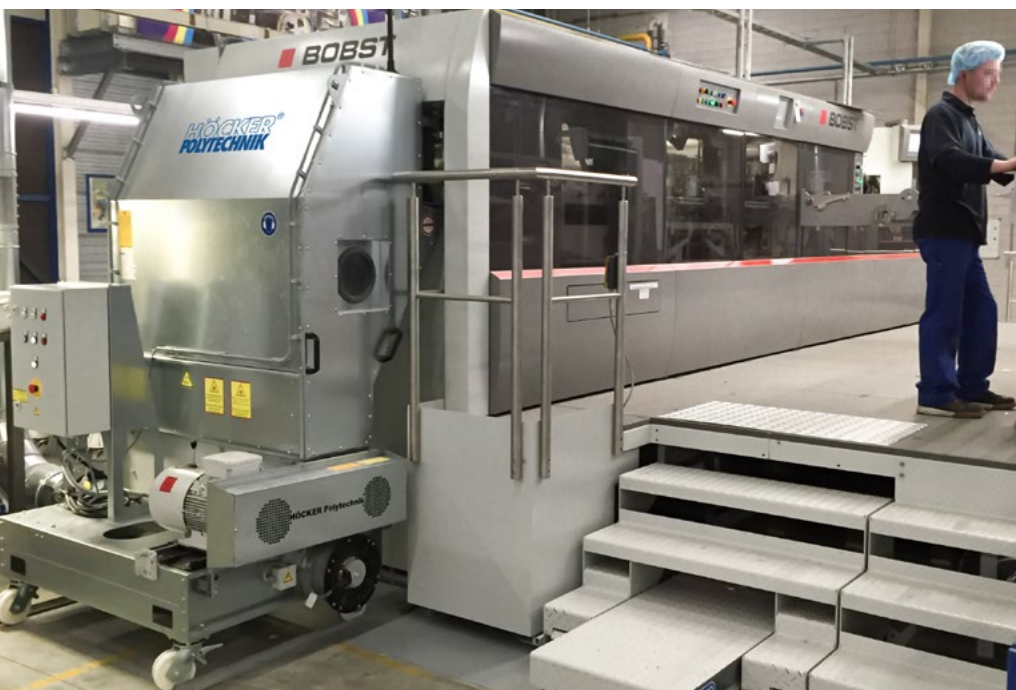
PHSS-K/G Shredder Sind auf ihr Einsatzgebiet hin spezialisiert und lassen sich mit jeder Stanze kombinieren.
