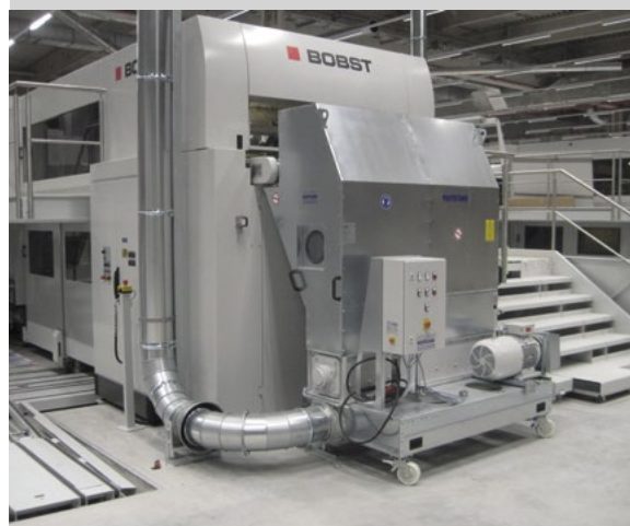
PHSS-K/G Shredder Stanzgitter-Greiferrandshredder mit Andockstation
