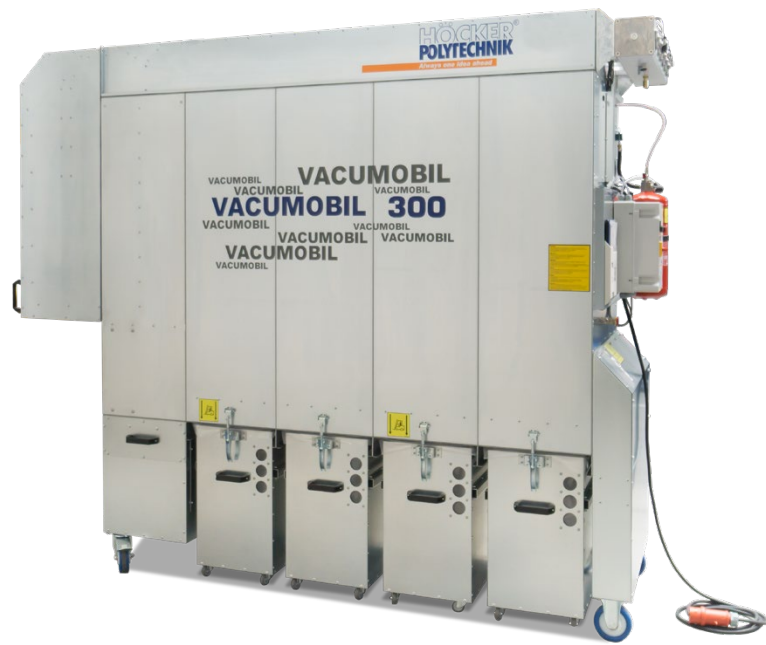
Vue ci-dessus: Vacumobil JT 300 décolmatage air(Jet), collecte tonneaux
