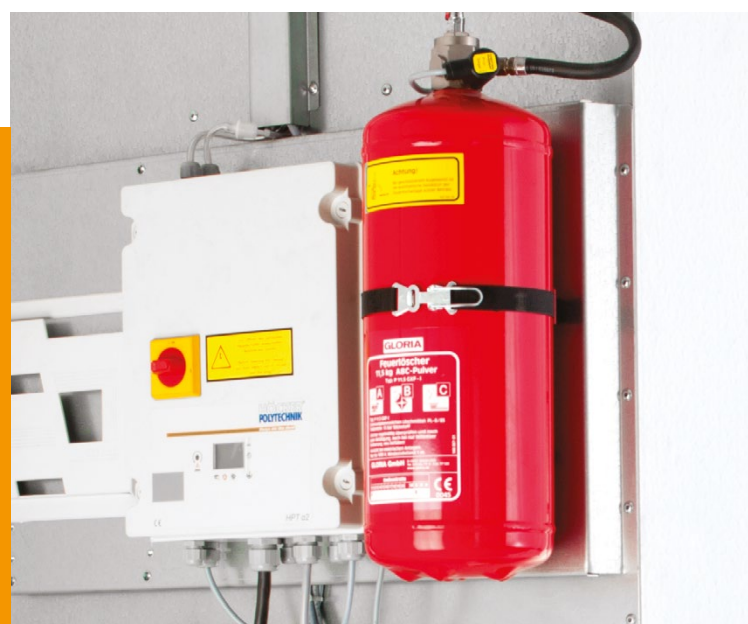
Vue dessous: Commande par automate programmable avec un affichage solide et un système de lutte contre l'incendie
