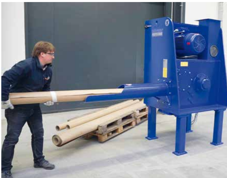
Der Hülsenshredder: Einfach einlegen und die Hülsen werden über die automatische Zuführung eingezo- gen. Foto: Höcker Polytechnik GmbH
